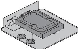
③ 推动硬盘，将硬盘插入对应的硬盘插座中。
