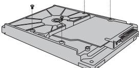
② 打开上盖，再将硬盘上的螺丝对准机箱底部预留孔。
