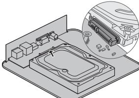
④ 拧紧硬盘固定螺丝，再将上盖安装回设备，并拧紧4颗壳体安装螺丝。
